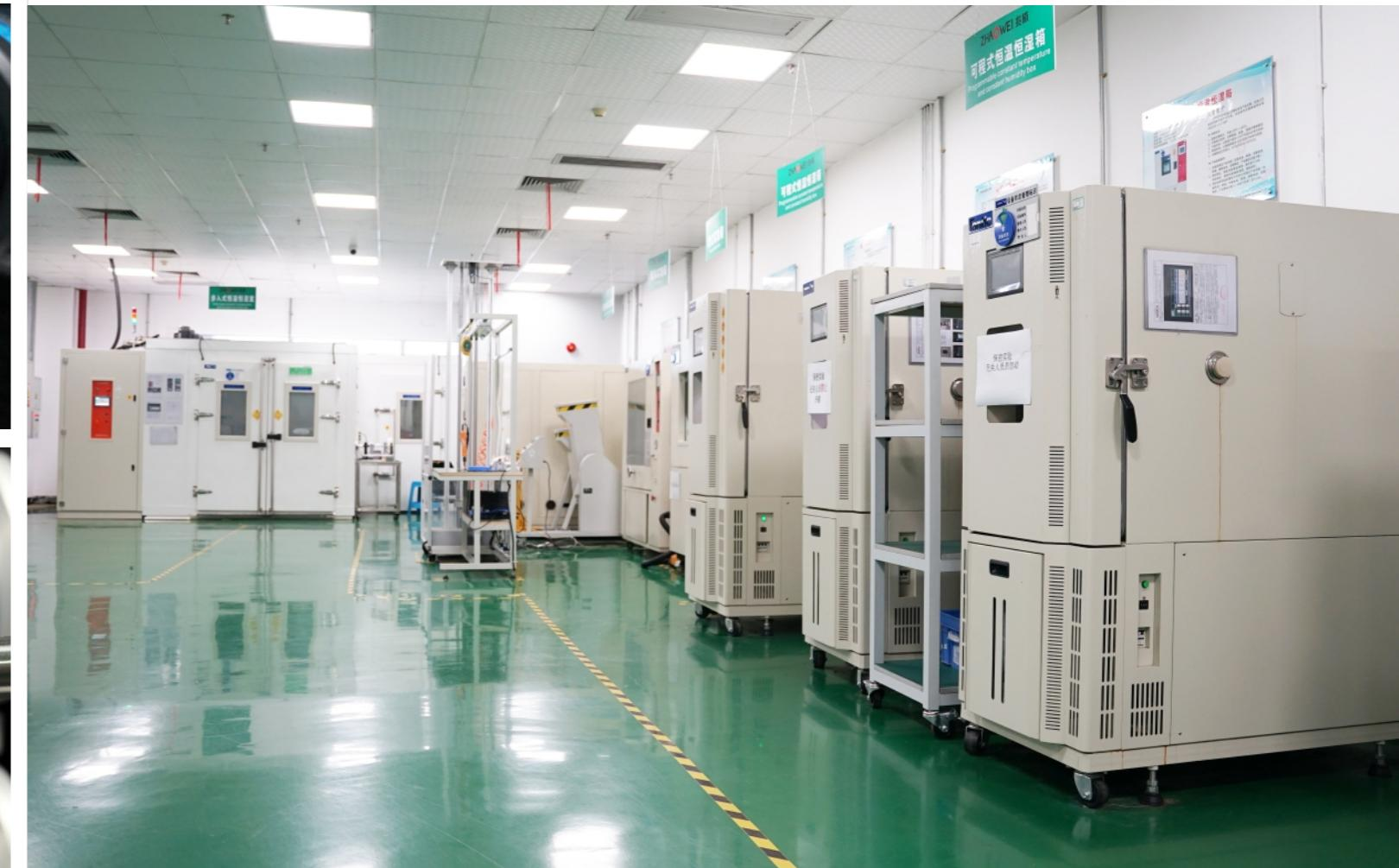
产品的可靠性及稳定性是评价产品技术水平的综合指标。为了能够分析、评价、验证和提高产品的可靠性，了解总成及零部件在失效情况下而获得可靠数据。兆威建立了驱动模块实验室——拥有多功能震动仪、恒温恒湿箱、冷热冲击试验箱、淋雨实验室、盐雾试验机、噪音室等多功能实验设备。
