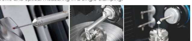
KLINGELNBERG(克林贝格)全自动精密测量中心,用于检查圆柱齿轮齿形、切割齿和剃齿刀、蜗轮蜗杆、滚刀、锥齿轮,以及轴对称工件的尺寸、形状和位置偏差,以及曲线和凸轮廓轴测量和转子测量。采用四轴联动测量技术,适用于各个形状的测量。全自动技术一次装夹中完成以下所有测量:齿轮测量、坐标点测量、形状和位置测量、粗糙度测量、轮廓测量和光学测量。
