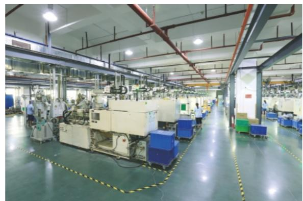
兆威所有成型注塑机都配备伺服机械手，提高生产效率的同时，也能提高产品品质的一致性。
