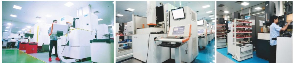
兆威精密加工中心拥有多款瑞士阿奇夏米尔加工设备，线切割机 CUT 1000 OilTech、CUT2000、CUT E 600、VP2、VP3；HMS500；安田YASDA 640V等加工设备。自动化精加工，使用EMAN智能管理系统及iMould自动化加工系统，为加工精度提供了保障。
